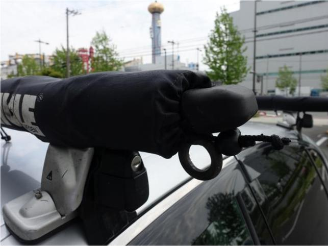
まずキャリアバーですが、私は **Thule** の 150 cm のものを使っています。長い物のほうが便利ですが、道路交通法上の制限（車幅をはみ出ない）もあるので気を付けてください。バーにはサーフィン用のパッドを取り付け、バーエンドには **Thule** のアイボルトを付けています。これが船を固定するラチェットベルトや、船台固定用のベルトを取り付けるのにとても便利です。物の割には高価なので、裏のボルトの始末さえできればホームセンターで売っているステンレス製のアイボルトでも
