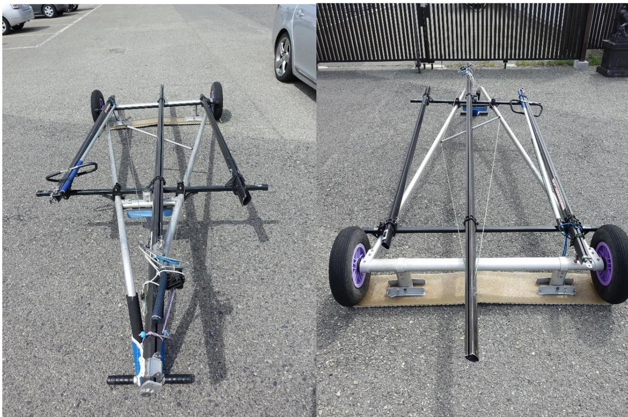
バーを船台に固定するのも、スパーをバーに取り付けるのも、どちらも PIAA TERO のスキー/マストホルダーを使用しています。
