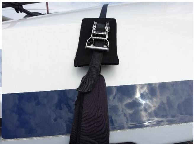
船の前後の固定は車の牽引フックの場所に応じてカヌーなどの固定用のロープラチェットを使用。
