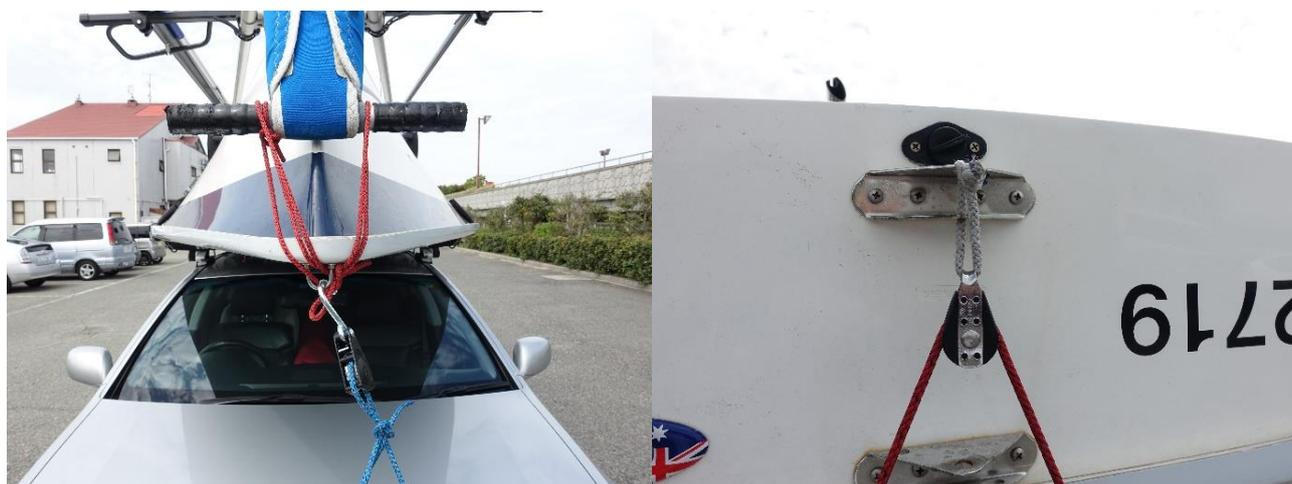
遠征中の移動をできるだけ快適に過ごすため、スパーを車内へ持ち込まずに、ローアマスト、トップマスト、ブーム+ウィスカー、全て船台にくくりつけています。
